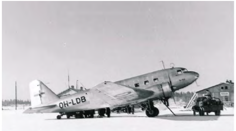
DC2 // OH-LDB "Sisu" Hyvinkään lentokentällä vuonna 1946, kuva Markon Haaviston kokoelma. Douglas DC-2 oli 14-paikkainen kaksimoottorinen matkustajalentokone, jonka valmistuksen Douglas Aircraft Company aloitti vuonna 1934. Se oli tehtaan vastaus Boeing 247 -matkustajakoneelle.
